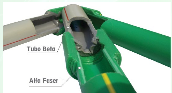
Unión sobrepuesta a termofusión. Tubería Beta (gris) no presenta anomalía en el exterior, no obstante, una sección en la unión permite dar cuenta del daño en la instalación. Tubería Faser (verde) no presenta deformación interior.
